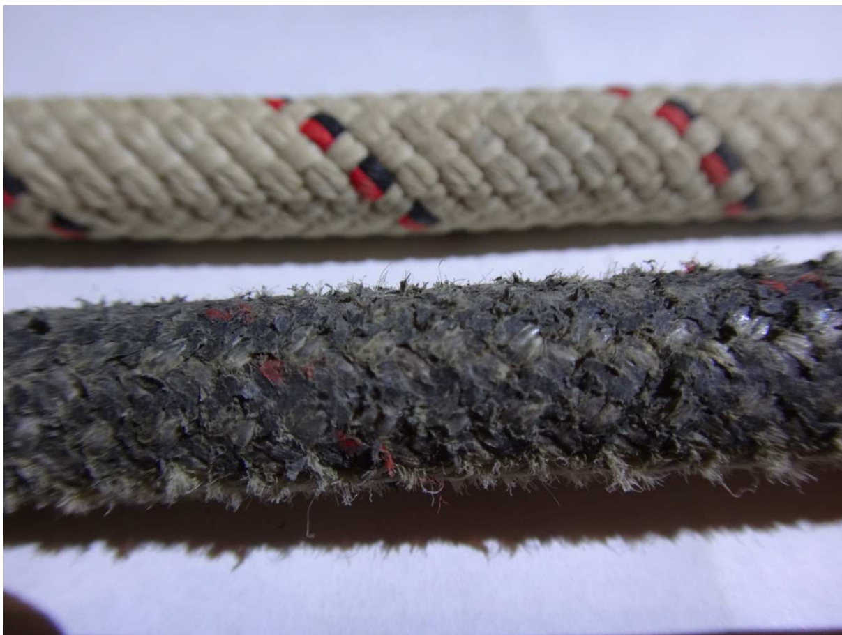
Corde du puits Garby après plus de 100 passages : en haut la main-courante, en bas milieu du puits
