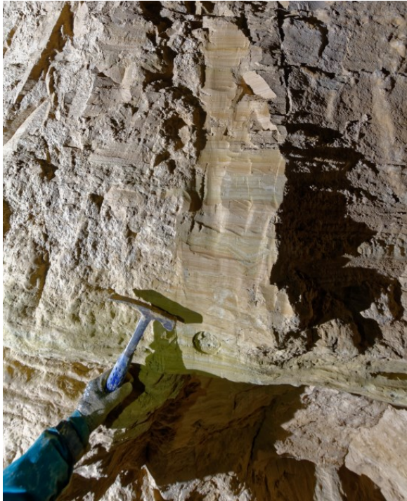
Une lentille sableuse est identifiée au milieu de la séquence détritique. Un prélèvement en tube PVC est réalisé pour une datation par la méthode OSL (luminescence stimulée optiquement). (clichés Matthieu Thomas)
