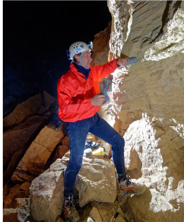
Une lentille sableuse est identifiée au milieu de la séquence détritique. Un prélèvement en tube PVC est réalisé pour une datation par la méthode OSL (luminescence stimulée optiquement). (clichés Matthieu Thomas)
